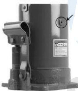
Na zdviháku nájdite gumenú zátku na odvzdušnenie a doplnenie oleja. Očistite oblasť zátky, aby sa po jej vybratí nedostala nečistota do hydraulického systému. Na tento úkon môžete použiť handričku namočenú v mydlovej vode.
