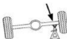
Po umiestnení nákladu zaistite vozidlo dielenskými stojanmi, vyberte bod poskytnutý výrobcom vozidla na jeho podopretie.
