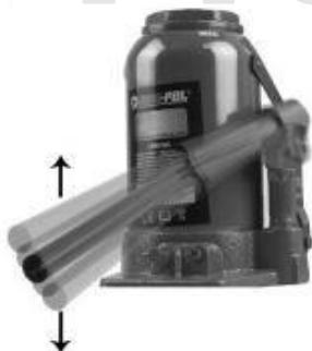
Zatvorte vypúšťací ventil a zdvihnite zdvihák do maximálnej výšky. Spusťte zdvihák na minimálnu výšku. Tým sa vytlačia vzduchové bubliny do zásobníka. Potom ventil zatvorte.
