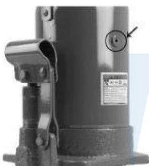
Na zdviháku nájdite gumenú zátku na odvzdušnenie a doplnenie oleja. Očistite oblasť zátky, aby sa po jej vybratí nedostala nečistota do hydraulického systému. Na tento úkon môžete použiť handričku namočenú v mydlovej vode.
